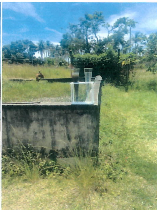
Nos Cones Imhoff, a esquerda amostra de esgoto bruto, no da direita amostra do esgoto tratado com alto grau de clarificação, demonstrando uma boa eficiência do Sistema UASB.
