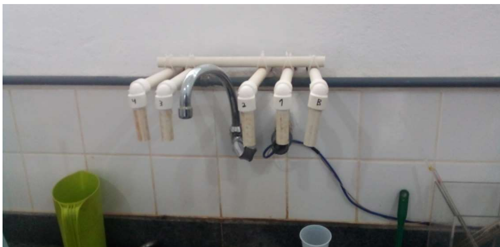
Pontos de coleta de amostras de água dos filtros e água bruta
