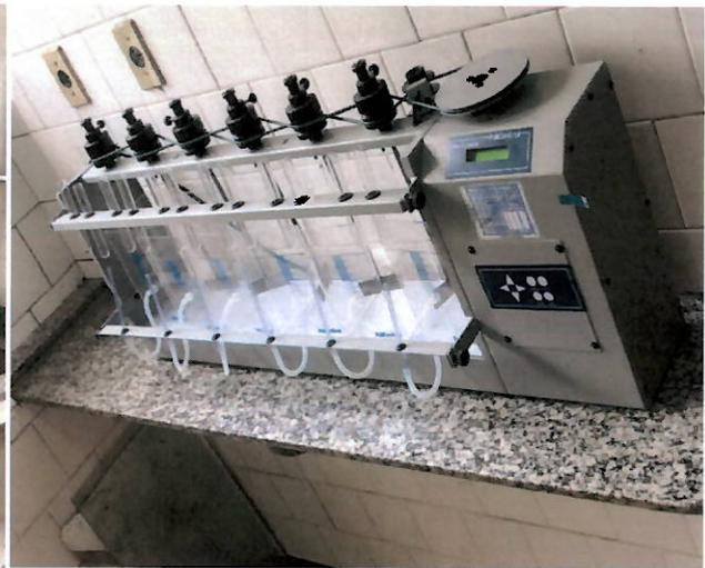
Aparelhos utilizados para análise da água + "Jar Test"
