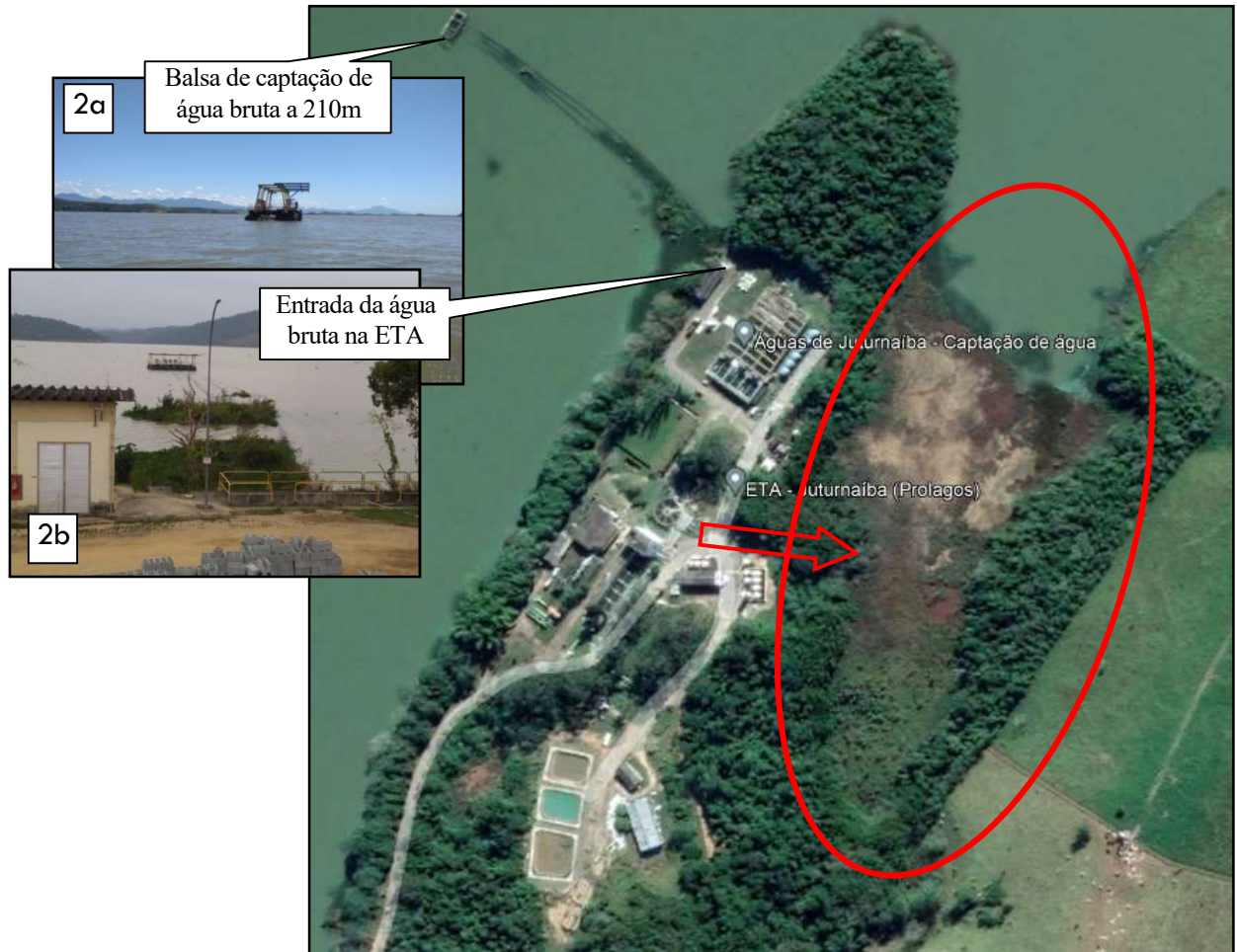
Figura 1-ETAs CAJ (imagem superior) e PROLAGOS (imagem inferior): passivos ambientais das pilhas de rejeitos de alumínio (dentro das elipses vermelhas. Fonte: fotos de satélite de 05/06/2022 do GOOGLE EARTH). Destaques para as estruturas de captação de água bruta na Lagoa de Juturnaíba das ETA's: 1) CAJ tomada lateral com elevatória de eixo vertical; 2) PROLAGOS tomada com elevatória em flutuante
