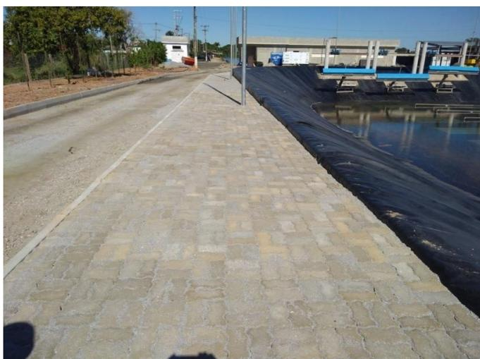
Foto 08 – Pavimentação no entorno da Lagoa feita com tijolos produzidos na usina de compostagem
