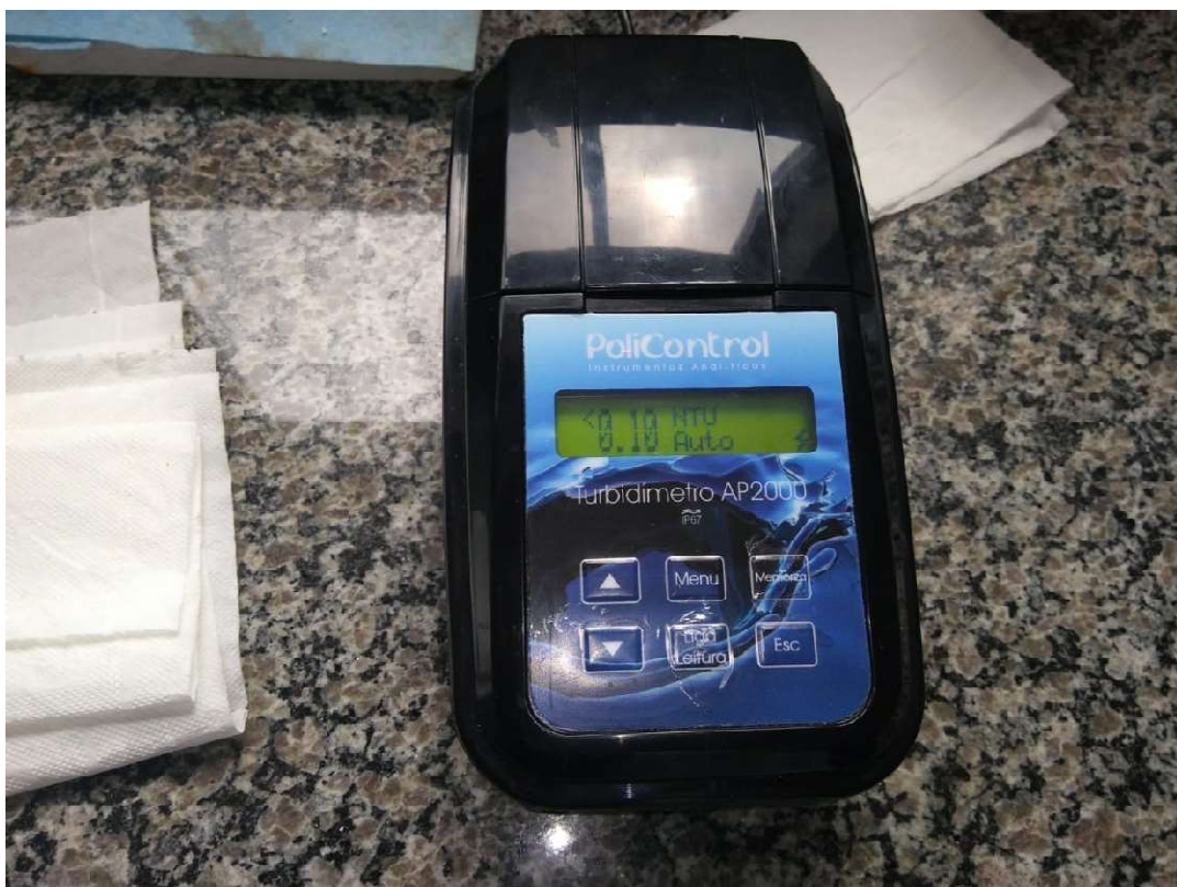
Fotografia 26 – Equipamento para Medição de Turbidez
