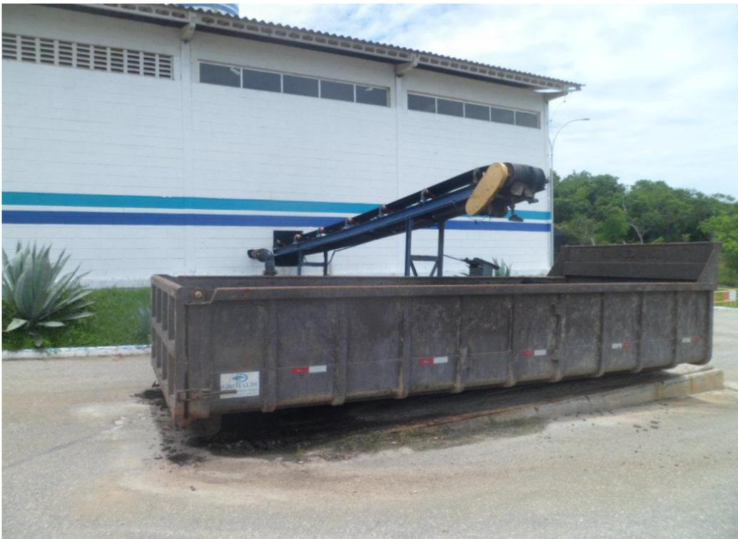
Foto 19 – Esteira de Retirada do Lodo e Lançamento na Caçamba
