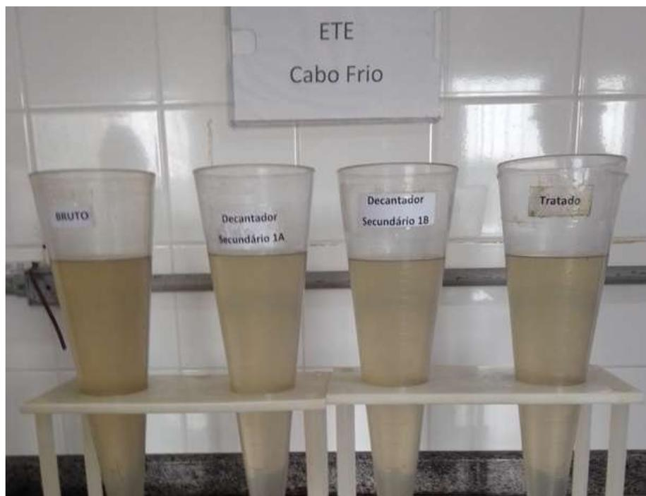
Figura 15 – Amostras dos esgotos da ETE (bruto, após decantadores e tratado)
