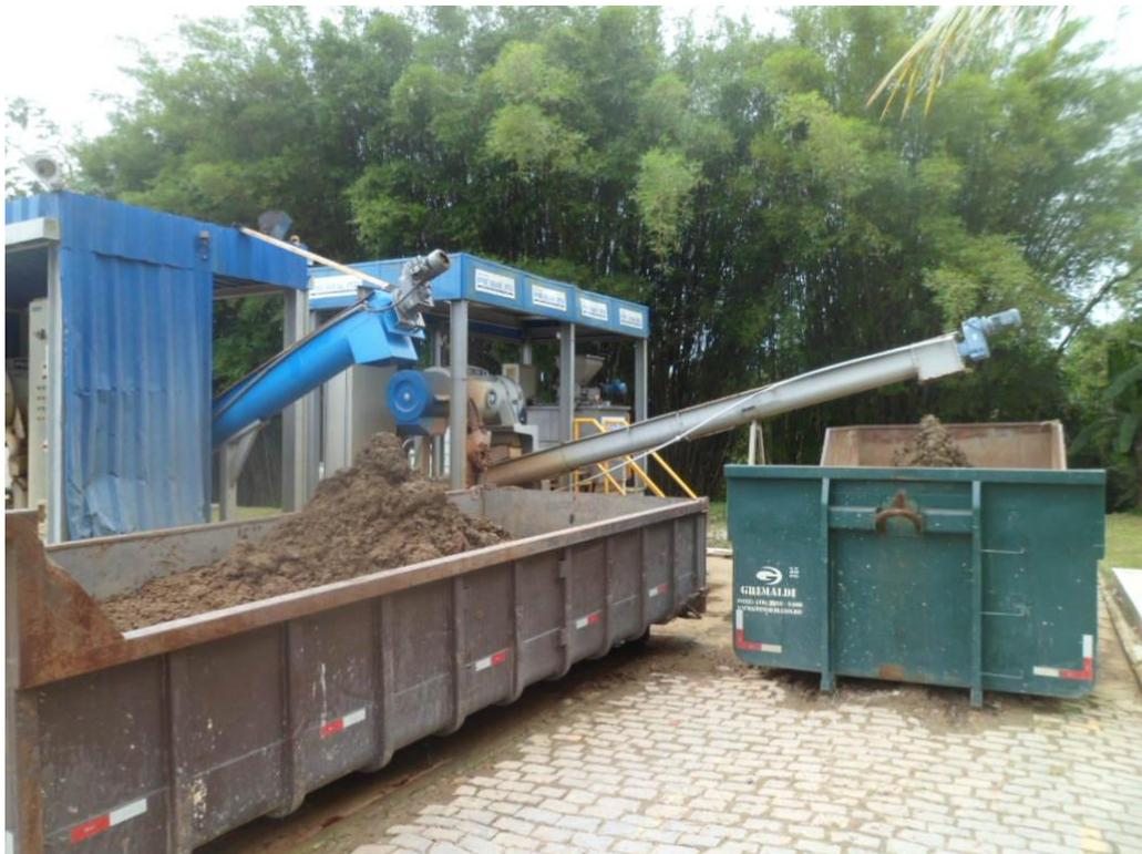
Foto 23 – Lançamento do Lodo Desidratado nas Caçambas 7m<sup>3</sup> Cada
