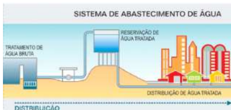
figura 1 – Modelo de abastecimento através de EEAT
