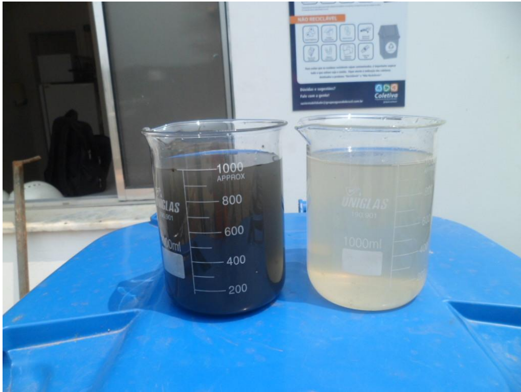
Foto 29 – Amostras do esgoto in natura e tratado
