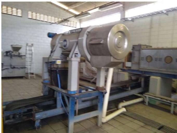
Foto 15 – Centrifuga Desidratação do Lodo
