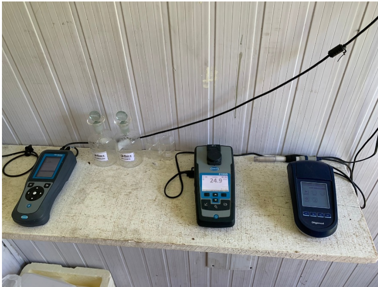
Figura 12 Equipamentos para aferição de PH, Oxigênio Dissolvido e Turbidez
