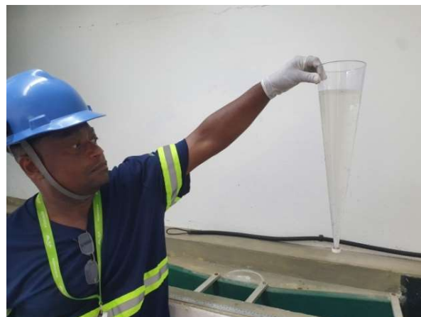
Foto 21 – Técnico retirando amostra do efluente tratado
