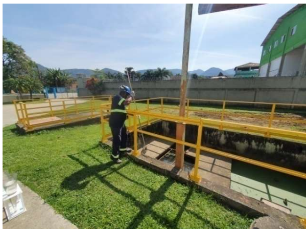
Foto 20 – Técnico retirando amostra do afluente bruto
