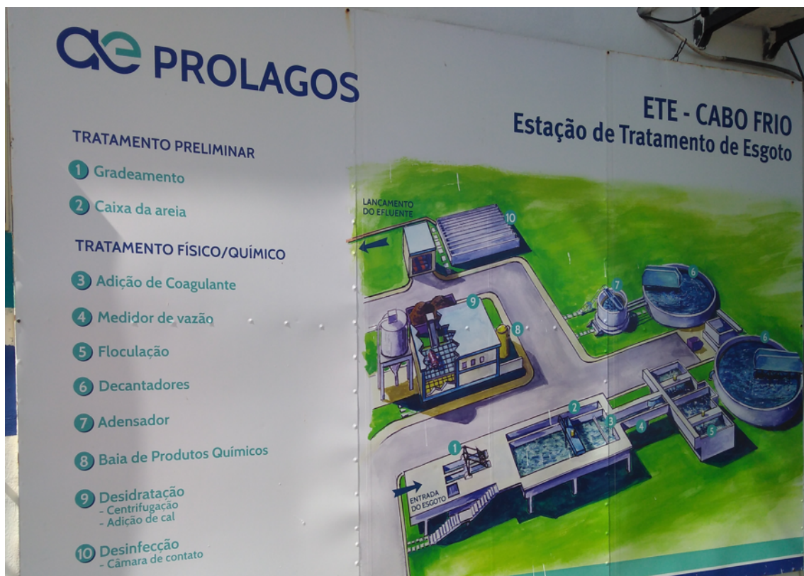
Quadro Esquemático da ETE Praia do Siqueira, afixado externamente na casa do operador/laboratório
