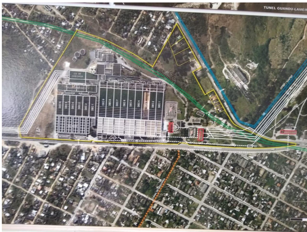
Visão aérea do encaminhamento do lodo ao Rio Cabenga (pontilhado abóbora)
