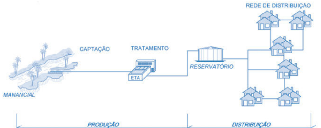
Figura 2 – Esquema Simplificado de um Sistema de Abastecimento
