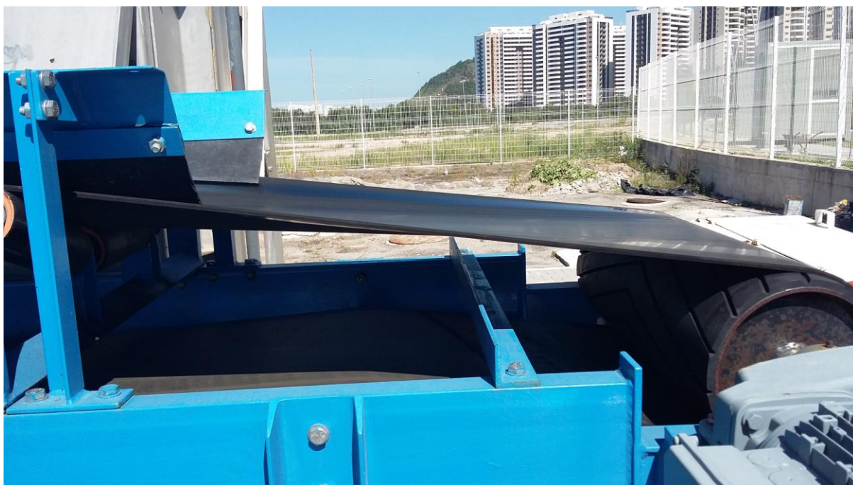
GRADE MECANIZADA - DETALHE DA ESTEIRA COLETORA
