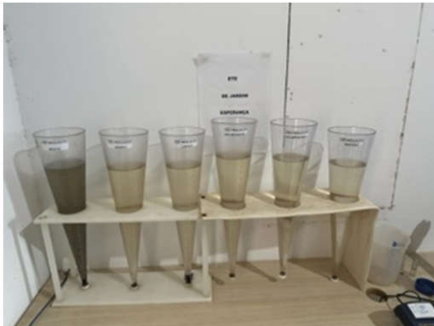
Figura 14 – Amostras no laboratório do efluente de cada etapa do tratamento (mais clarificado da esquerda para a direita, ou seja, de montante para jusante da ETE)
