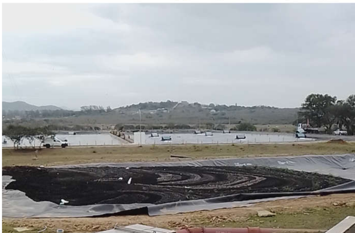
Figura 13 – Depósito de lodo das ETEs da PROLAGOS sobre mantas impermeáveis, objetivando testes para aproveitamento agrícola. Desidratação final do lodo a céu aberto por evaporação.
