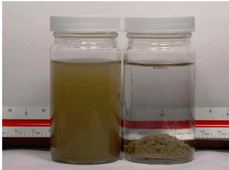
Figura 1: Demonstra como floculantes naturais auxiliam na deposição dos sedimentos.
