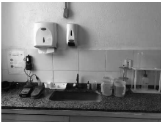
Figura A.25 – Bancada e equipamentos utilizados para a realização de testes de pH e turbidez nas amostras de água do rio coletadas a montante e a jusante da ETR.
