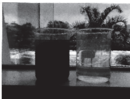
Figura A.26 – Amostras de água do rio coletadas a montante (à esquerda) e a jusante (à direita) da ETR no momento da vistoria.
