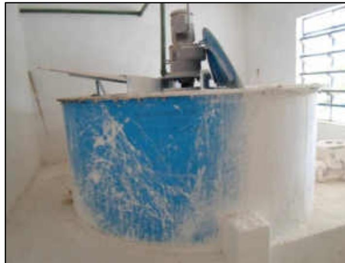
5.26.12. ETA E CAPTAÇÃO ITAPERUNA - MISTURADOR DE CAL ( MOTOR DE INDUÇÃO) NA WEG NA 0,5 CV
