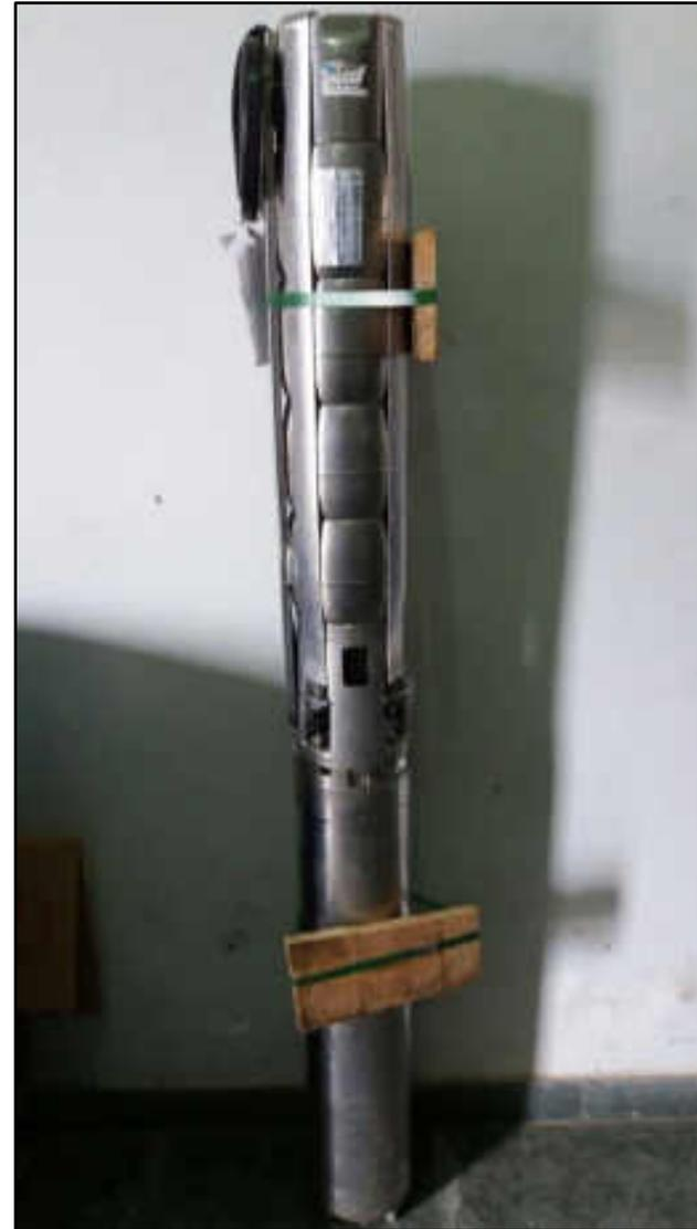
6.2.1. POÇO BARRACÃO - BOMBA DE POÇO PROFUNDO EBARA NA 15 CV
