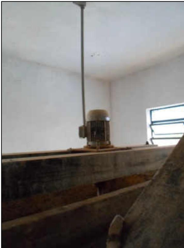
5.26.11. ETA E CAPTAÇÃO ITAPERUNA - MISTURADOR DE CAL ( MOTOR DE INDUÇÃO) NA WEG NA 0,5 CV
