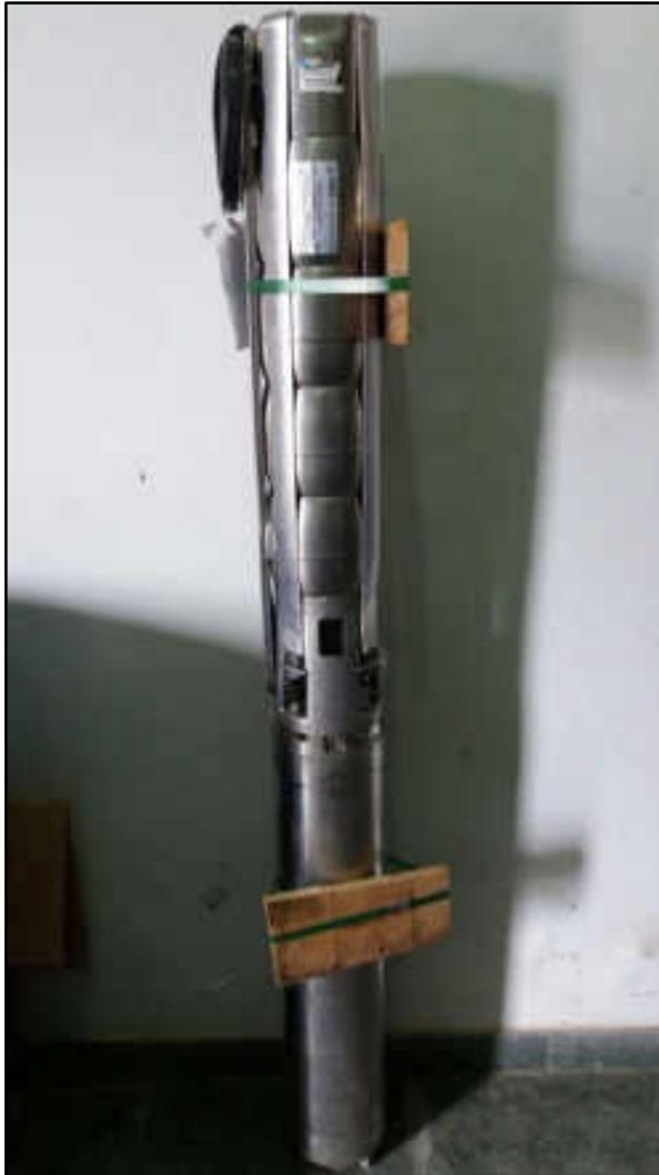
6.4.1. POÇO MÁQUINAS - BOMBA DE POÇO PROFUNDO NA EBARA NA 15 CV
