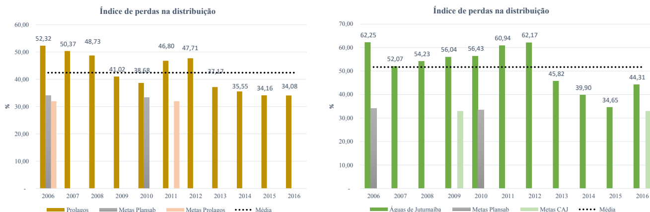
Figura 107: IN049 - Índice de perdas na distribuição (%) - Prolagos (laranja) e Águas de Juturnaíba (verde) 2006-2016
